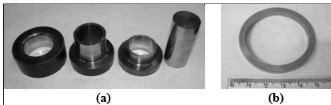
Figura 1 – Amostras na forma de anel – (a) Matriz – (b) Corpo de Prova
