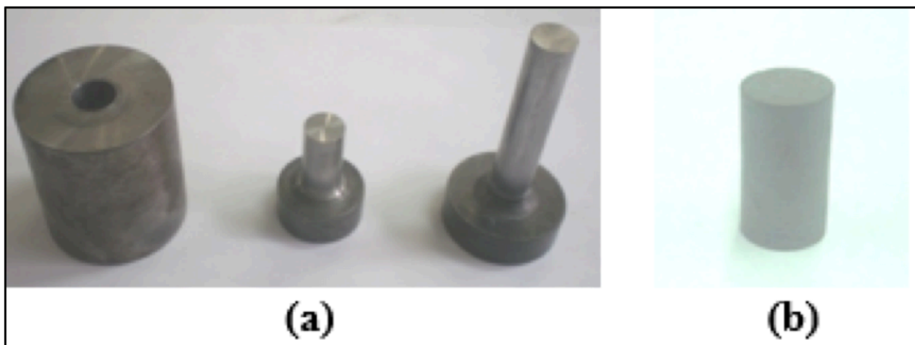
Figura 2 – Amostras na forma de cilindro – (a) Matriz – (b) Corpo de Prova
